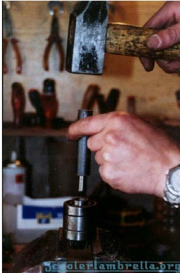
**Remarque** : Suivant l'année, les roulements peuvent être des 6004 ou 16004..... démonter avant de passer commande!
